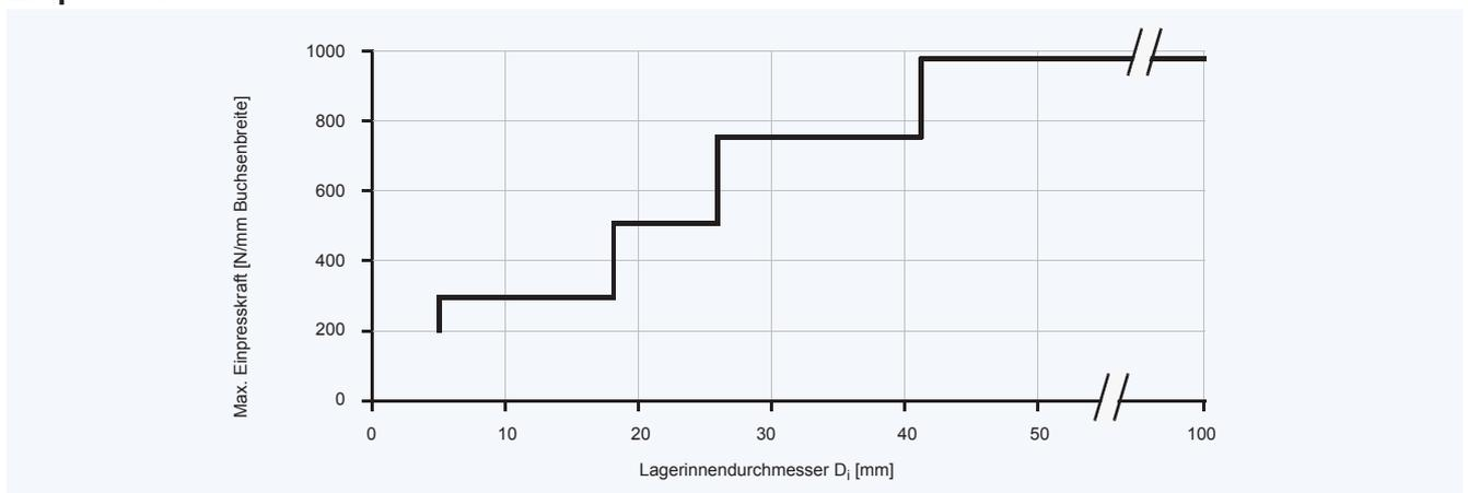
Abb. 28: Einpresskräfte
