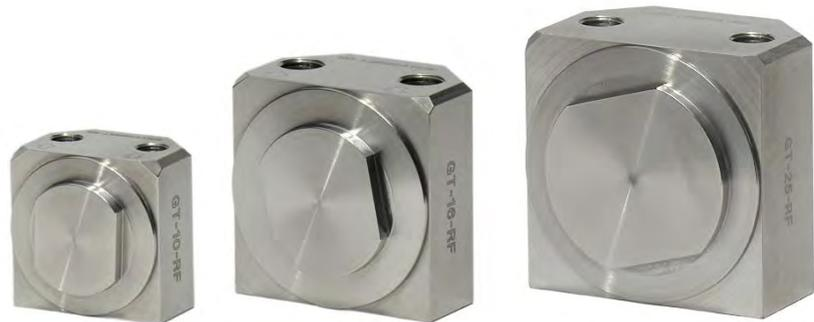
Die Turbinenvibratoren der GT-...-RF Serie entsprechen in Ihren Leistungswerten den entsprechenden Typen der GT- Serie, Gehäuse und Verschlußdeckel sind jedoch in Edelstahl ausgeführt, d.h. die komplette Außenfläche ist rostfrei. Sie eignen sich daher besonders für den Einsatz in der Nahrungsmittel- sowie der chemischen- bzw. pharmazeutischen-Industrie und überall dort, wo der Einsatz von pulverbeschichteten- und Aluminium-Oberflächen nicht erwünscht ist.
