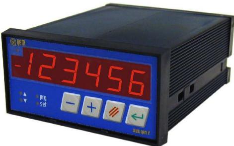
MC235.09 è un visualizzatore di quota che oltre a visualizzare la posizione dell'asse fornisce 4 uscite, programmabili sia nella quota che nella logica di intervento, che lo rendono funzionale come misuratore e come controllore della posizione visualizzata rispetto alle misure preimpostate o autoapprese.
