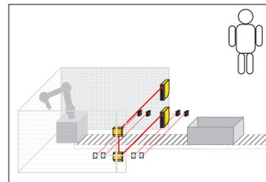
Bild 8/6 Zugangssicherung mit Muting
