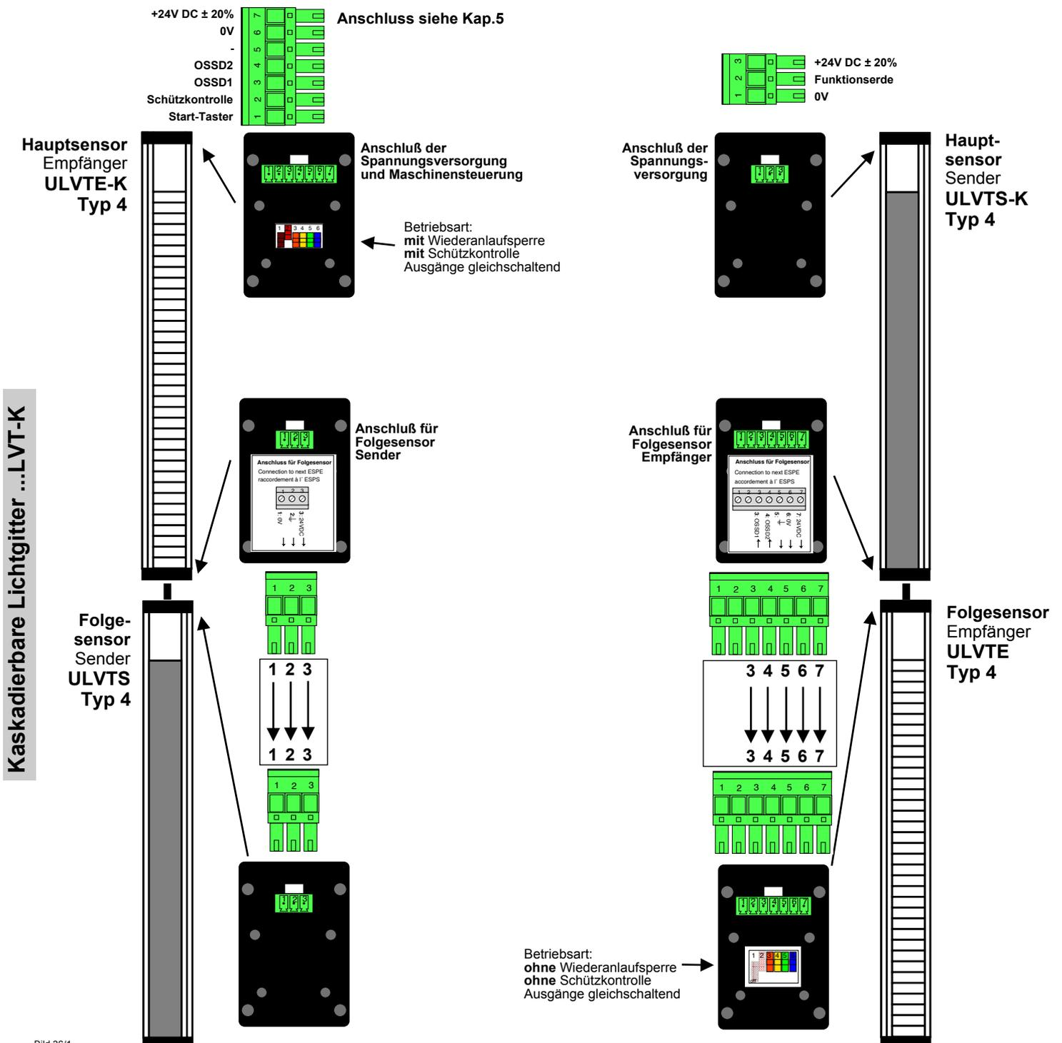
**8.8.2 Anschlußbeispiel 2:** Hauptsensor **ULVTK (Typ 4 Lichtgitter)**, Folgesensor **TLVT (Typ 2 Lichtgitter)**
