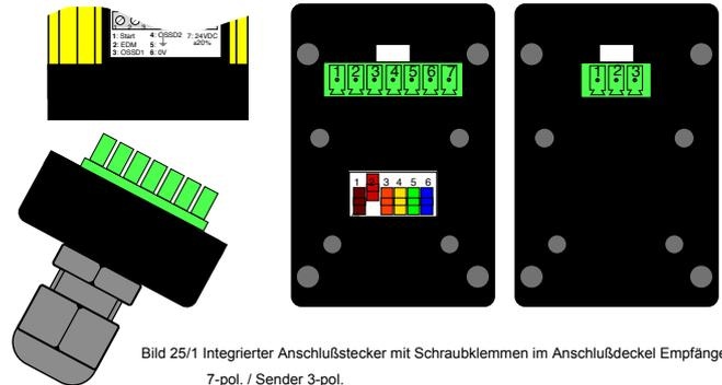
Bild 25/1 Integrierter Anschlußstecker mit Schraubklemmen im Anschlußdeckel Empfänger 7-pol. / Sender 3-pol.
