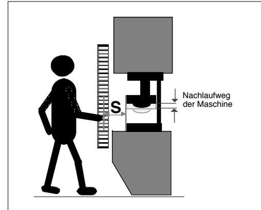
Bild 14/1 Vertikale Gefahrstellenabsicherung
