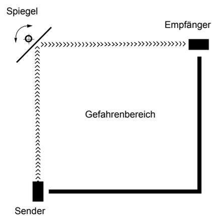
Bild 21/3 Anordnung über 1 Umlenkspiegel
