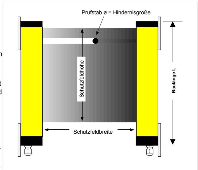
Bild 9/1 Sender und Empfänger bilden das Schutzfeld
