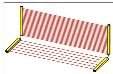
Bild 17/4 Kaskadierung von Sicherheitslichtvorhängen
